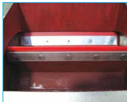
Rotore con bavette intercambiabili
